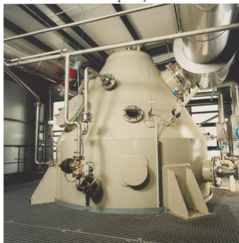
FC crystallizer for \text{FeSO}_4 \cdot 7\text{H}_2\text{O}
