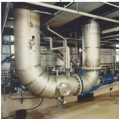
FC crystallizer for \text{FeSO}_4 \cdot 7\text{H}_2\text{O} ; pump position
